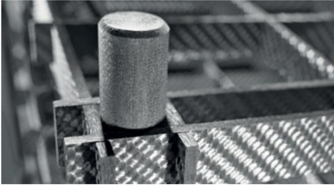
↑ Eckverbinder in einer Kombination aus CFC und Graphit im modularen Baukastensystem
