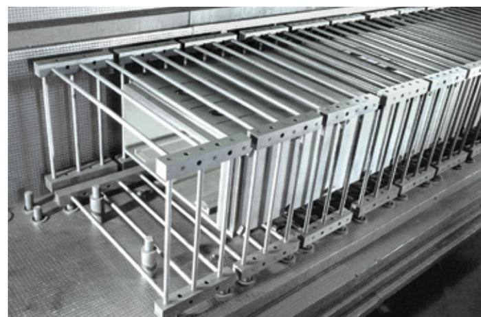
↑ Kontinuierlicher Hochtemperaturofen, konstruiert mit SIGRAFINE Heizer und Muffel sowie Isolierung aus SGRATHERM Hartfilz
