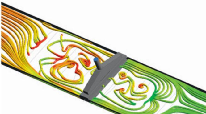
↑ FEM-CFD Simulation des Gasstroms durch einen kontinuierlichen Hochtemperaturofen
