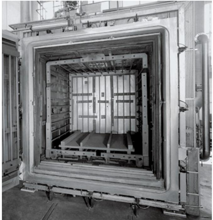
↑ Hochtemperaturofen, isoliert mit SGRATHERM Hartfilz und ausgestattet mit einem langlebigen SIGRAFINE Graphit-Heizkäfig
