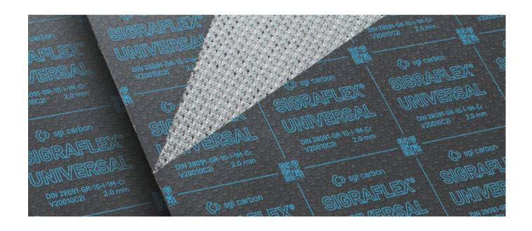
SIGRAFLEX UNIVERSAL一种不含粘合剂的石墨密封板材,由柔性石墨箔制成,带有一个或两个冲刺不锈钢增强。板材经过特殊浸渍防粘处理,以提高密封性,同时适合装卸。
