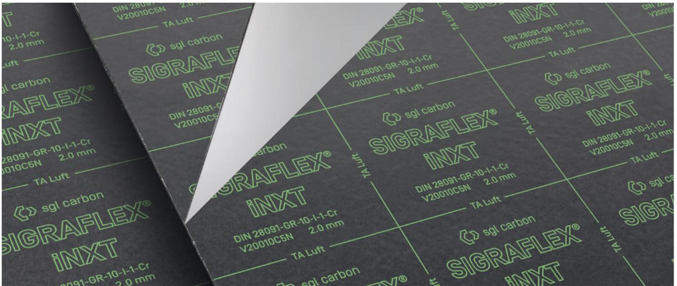
SIGRAFLEX iNXT ist eine Graphitdichtungsplatte aus flexiblen SIGRAFLEX Graphitfolien, die mit einer Glattblecheinlage aus Edelstahl verstärkt ist. Zur Reduzierung der Leckage ist das Dichtungsmaterial mit einer Imprägnierung versehen. Eine Oberflächenveredelung verbessert die Anti-Stick-Eigenschaften.
